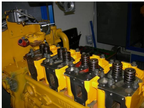
Einbau neue Zylinderköpfe
