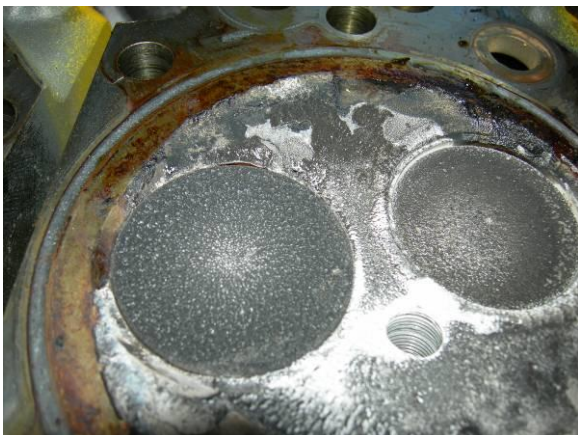
Alter Zylinderkopf mit stark eingeschlagenem Auslassventil und starken Siliziumablagerungen
