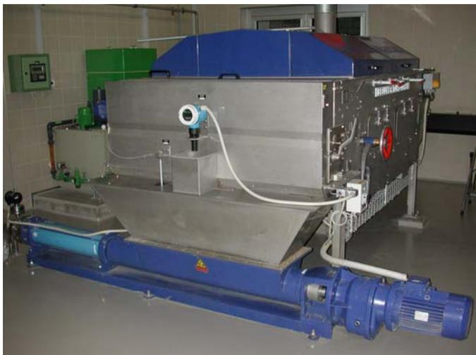
Der in der Vorklärung anfallende Mischschlamm (Primär- und Überschussschlamm aus der Biologie) wird über eine Strainpresse (Schlammsiebung) in einen Zwischenstapel gepumpt. Über Dosierpumpen gelangt der Schlamm weiter auf den Sehtisch, wo er vor-entwässert wird. Mit der Vor-entwässerung kann die Schlammmenge auf etwa die Hälfte ihres Volumens reduziert werden. Das Filtrat der Entwässerung wird in den Zulauf der Kläranlage zurückgeführt.
