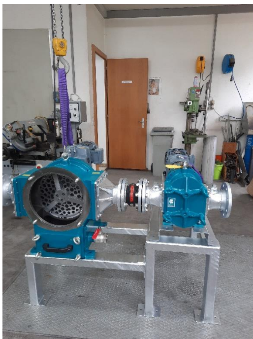
Konstruktion des Unterbaus und Zusammenbau der Aggregate
