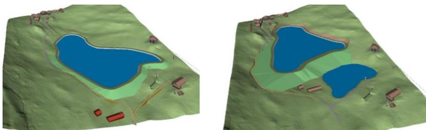
Abbildung 6: Visualisierung einer möglichen Speichersee-Erweiterung: Varianten ein-See und zwei-Seen (Quelle: Steiger Ingenieure + Planer AG)
