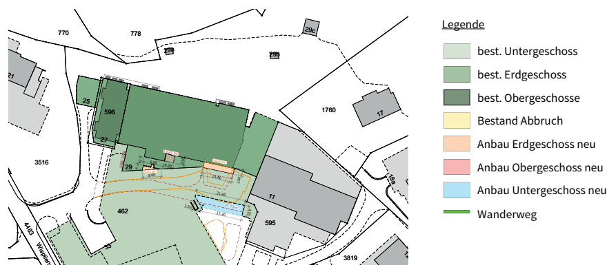
Abb. 6 Übersicht Vorhaben Renovation und Umbau Grand Hotel Park (Quelle: Jaggi Swiss, Sept. 2022)
