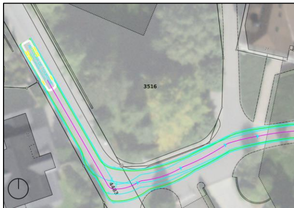
Abb. 13: Schleppkurvenprüfung Knoten «Hotelvorfahrt/Wispilenstrasse» (Einfahrt Reisecar)
