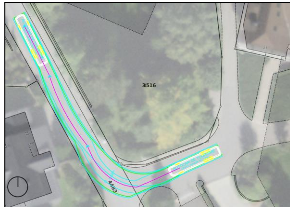
Abb. 14: Schleppkurvenprüfung Knoten «Hotelzufahrt/Wispilenstrasse» (Ausfahrt Reisecar)
