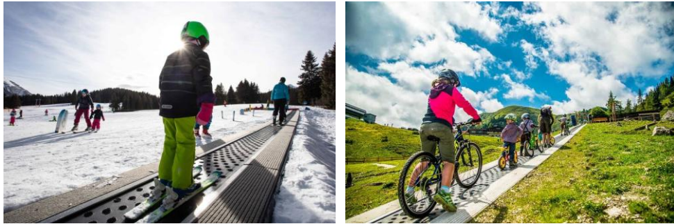
Abbildung 9: Beispiel für Doppelnutzung Förderbandanlage (Zauberteppich) Skianfängerpark im Winter und Bikepark im Sommer (Quelle: Sunkid)
