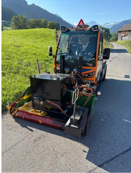
Bitumen Küche für Rissanierung
